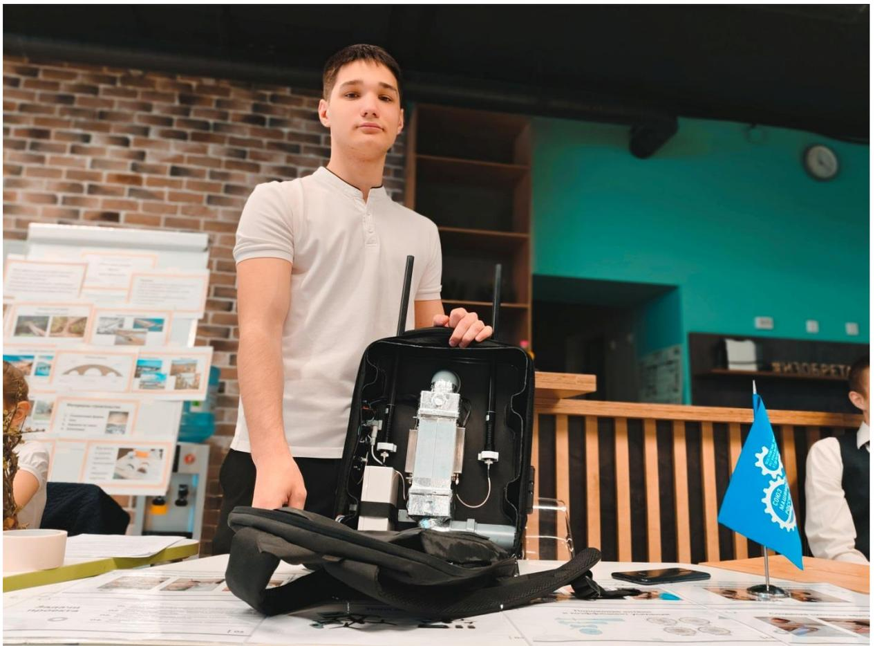
В рамках проекта создано портативное устройство для борьбы с боевыми дронами. За счет создания радиоэлектронных помех прибор блокирует связь дрона с управляющим устройством, в результате чего дрон
